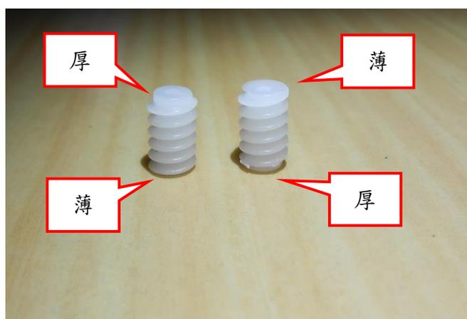
→觀察白色塑膠的厚薄，記得靠近馬達的那端是厚的，而靠近外面那端則是薄的。最後將馬達上的圓柱穿過白色塑膠中心的圓孔內。
