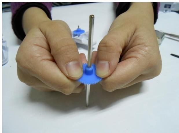
→找出步驟 2 內的 2 號齒輪，並從零件袋內找出最長的六角柱棒，將六角柱穿過齒輪中心的孔洞內。(需要較大的力氣)
