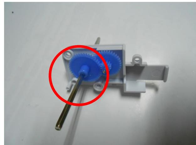
→依照上圖的方式，將 2 號齒輪與六角柱棒穿過標示 F 的圓孔。(可以看步驟 9 的圖片)
