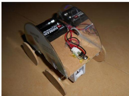
→開啟電源，找出前輪的位置，將**電池盒用熱熔膠黏在車子前端**，機械龍貓車即完成囉！
